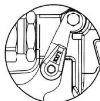
Spust odryglowany (pistolet natryskuje)
